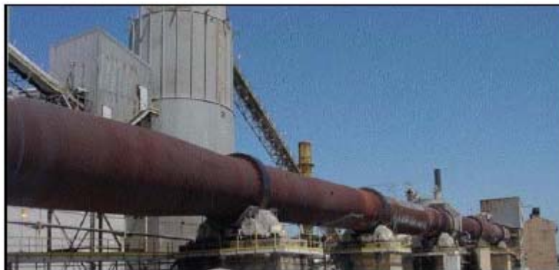
Рис. 2.31 Длинная вращающаяся печь для производства извести
