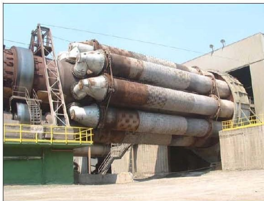
Рис. 1.18. Планетарный рекуператорный клинкерный холодильник [45, 90]
