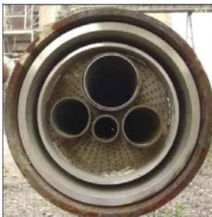
Рис.1.11. Образец многоканальной форсунки [107]
