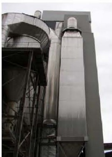
Рис. 1.66 Пример установки SCR [140]
