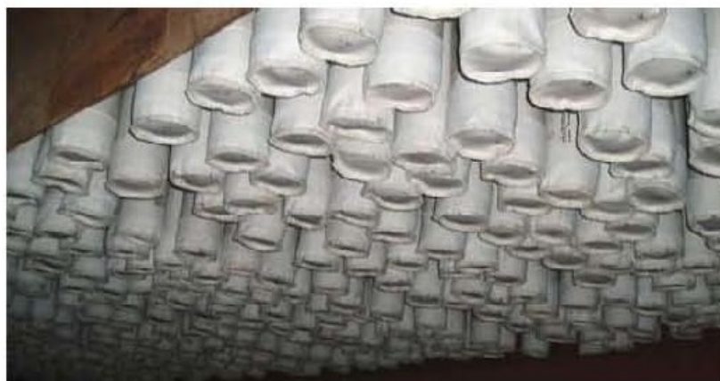
Рис. 1.60. Пример рукавного фильтра и фильтрующего материала, используемых на цементном заводе в Соединенном Королевстве [82].
