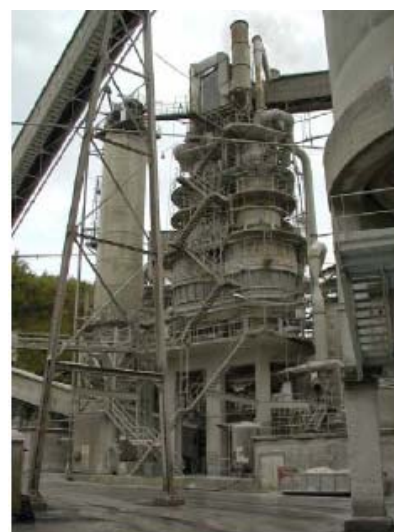
Рис. 2.23 Регенеративная печь с параллельным потоком материала (PFRK) [44]
